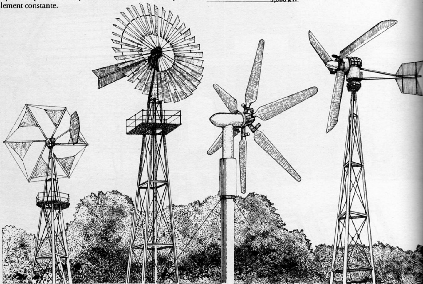
C'est une variante des moulins méditerranéens. Utilisée par les maraîchers crétois pour pomper l'eau nécessaire à l'irrigation, elle ne posera aucun problème à un bricoleur.
